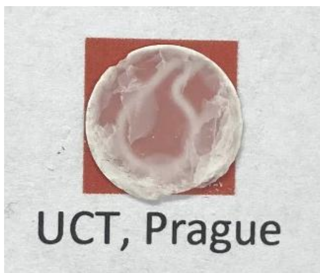
Obrázek 1: Vzorek \text{CaF}_2 keramiky připravený metodou cold sintering (teplota 350 °C, tlak 400 MPa, délka výdrže 60 minut, kapalná fáze 2M roztok LiCl).
