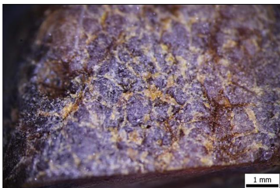
Povrch modelového vzorku jantaru před a po konsolidaci 10% roztokem Paraloidu B72 v xylenu
